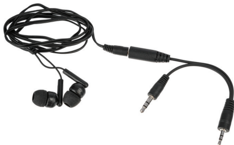
Рисунок 31. Подключение наушников к сплиттер адаптеру
