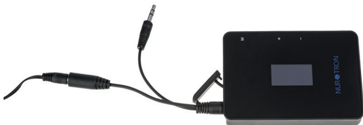
Рисунок 32. Подключение сплиттер адаптера к нательному аккумулятору
